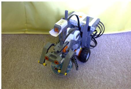
Am Heck von Version 2 ist ein Touchsensor angebracht, welcher entfernt wird, um Marvin weiter zu verkleinern. Der Ultraschallsensor befindet sich nun an der Spitze, direkt über dem Ball und kann seiner Aufgabe nun besser nachkommen. Zusätzlich wurde ein Lichtsensor eingebaut, der ausschließlich der Ballsuche dient.
