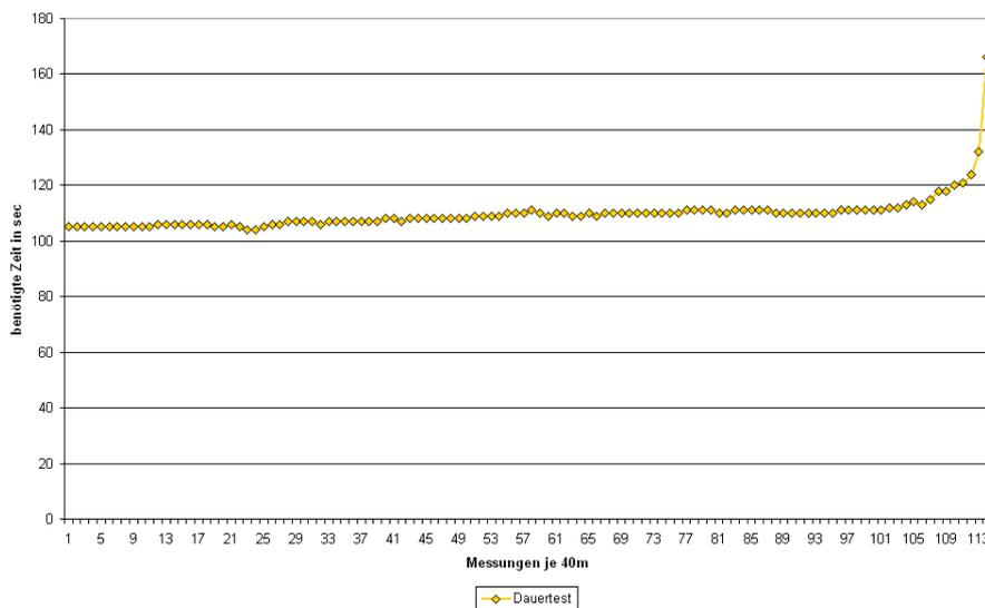
Am Anfang wird zum Abfahren der Strecke eine Zeit von etwas über 100 Sekunden benötigt. Diese steigt dann im Laufe der Zeit etwa linear, allerdings nur in geringem Maße, bricht dann jedoch sehr plötzlich nach oben aus. Die mit einer Akkuladung bewältigte Strecke beträgt ca. 4532 Meter. Die Gesamtlaufzeit liegt bei 3 Stunden, 26 Minuten und 29 Sekunden, was als sehr gut angesehen werden kann.
