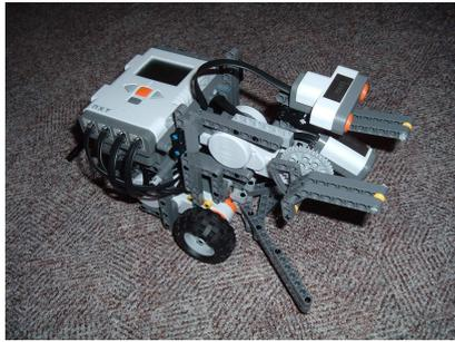
Da der NXT-Baustein das schwerste Element darstellt, wird dieser bei der zweiten Version so tief wie möglich angebracht, ohne jedoch in eine andere Richtung zu wachsen. Es wird Fahrstabilität gewonnen, ohne neue Nachteile in Kauf nehmen zu müssen. Der Ultraschallsensor war jedoch immer noch zu hoch angebracht, was eine dritte Version nötig machte.
