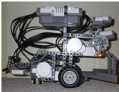
Die erste Version von Marvin wurde sehr hoch, was bei hartem Bremsen fast zum Umkippen führte. Das besondere an dieser Version ist, dass der Lichtsensor sich durch den Vorgang des Greifens nach oben zur Taschenlampe ausrichtet und so nicht durch den Ball gestört wird. Der Ultraschallsensor bei diesem Modell war allerdings viel zu hoch angebracht für das beschriebene Szenario. So musste hier nachbessert werden.
