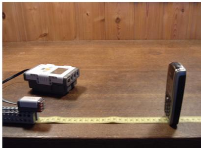
Zur Messung des Akustiksensoren wird ein Mobilfunktelefon verwendet, welches in diskreten Abständen im Bereich von 5cm bis 100cm, mit dem Lautsprecher auf den Sensor ausgerichtet, durch den gleichen Klingelton in drei unterschiedlichen Lautstärken den Sensor anregt. Die Messung erfolgt in Prozent-Angaben. Auf eine geringe Umgebungslautstärke wurde genau geachtet. Diese lag in Messwerten des Sensors unter
