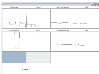
Um die Aufgabe zu lösen, verwenden wir die Bibliothek iCommand für Java. Diese erlaubt es, dem NXT Befehle während der Laufzeit über Bluetooth zu senden und Messwerte zu erfragen. Die Steuerung des Roboters erfolgt mit Hilfe der Tastatur. Die Tasten W,A,S,D dienen zur Bewegung in beliebige Richtung, R und F legen die Geschwindigkeit fest, O und L wurden zum Öffnen und Schließen des Greifers gewählt.
