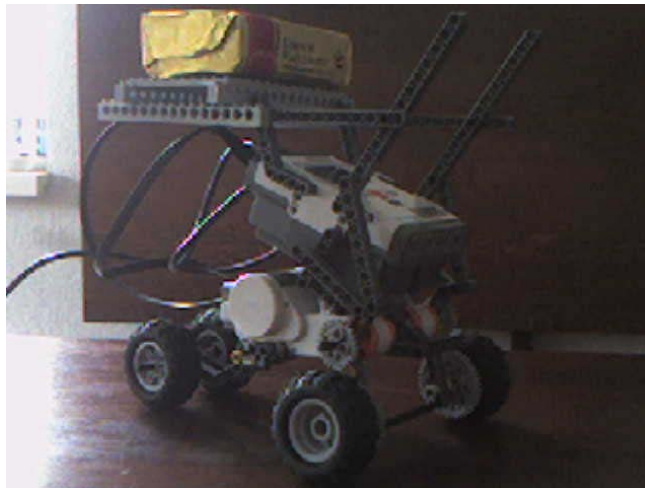
Bild 2 : LEGO Modell für die Motorenbelastung
