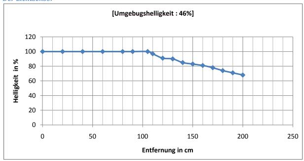
Der Lichtsensor hat zwei Operationsmodi, Ambientlight und Reflectedlight. Mit dem Modi Ambientlight misst man die Umgebungshelligkeit und mit dem Modi Reflectedlight können Farben gemessen werden.
