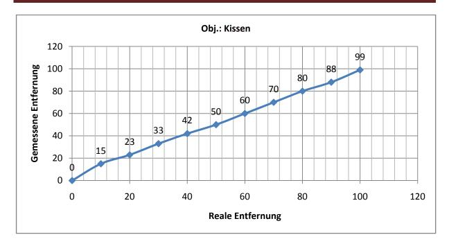
Durch die Messungen die wir mit dem Ultraschallsensor gemacht haben, können wir abschließend sagen, dass der Sensor mit einer Abweichung von ca. ± 3cm relative genau arbeitet und das die Reichweite ca. 150 cm beträgt, wobei diese vom Material abhängig ist.
